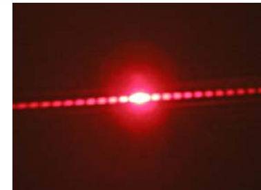
Diffrakciós kép vékony drótszálról.
